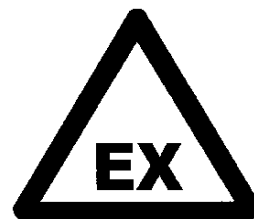
Zona con riesgos de atmósferas explosivas
