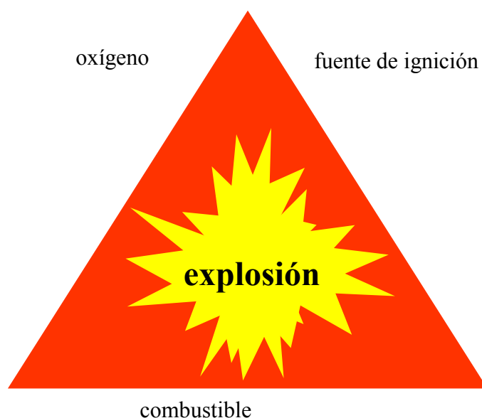
Figura 1.2: Triángulo de explosión
