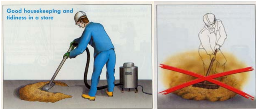
Figura 3.2: Eliminación de depósitos de polvo 4
