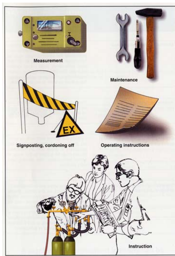
Figura 4.1: Ejemplos de medidas organizativas en la protección de explosiones 4
